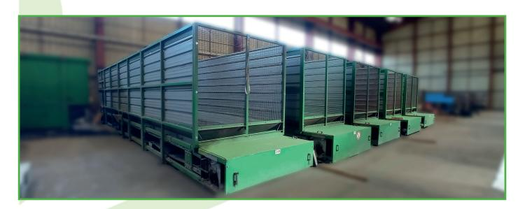
Le silo sur base TBU, SIL-TBU est un équipement industriel à usage intensif de type stockage dynamique. Ce silo sur convoyeur extracteur TBU est destiné au stockage et à l'évacuation de produits triés vers ligne de conditionnement, ou installé au coeur d'un process de tri en tant que silo tampon pour le tri à rupture de charge.
