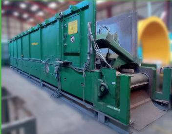
L'ouvre-sacs est un équipement industriel à usage intensif qui permet l'ouverture et le vidage des sacs plastiques contenus dans les collectes sélectives ou d'ordures ménagères brutes. Il assure la régulation du débit de la ligne de tri.
